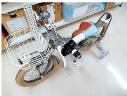
ソケット状の自助具が付いた子ども用自転車。安全面でも様々な工夫が取り入れられている
